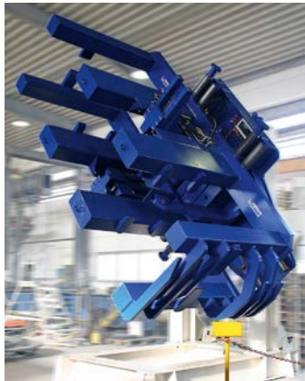
25T251W/099 - Volteador de chapas de acero
